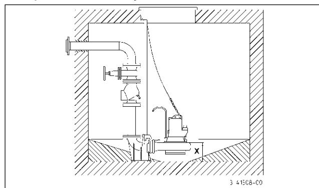
**Montaj:** Prindeți cu dibluri piciorul cuplajului de fundul puțului colector și montați apoi glisierele. După aceea montați conducta de alimentare inclusiv armaturile necesare ca supapa fluture și ventilul de închidere.
