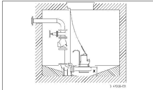
**Beszereles:** Erősítse fel a csatlakozót a gyűjtőakna padlójára, majd szerelje fel a vezetőcsövet! Azután építse be a nyomóvezetéket a szükséges armatúrákkal (például visszacsapószelep, tolózár) együtt.
