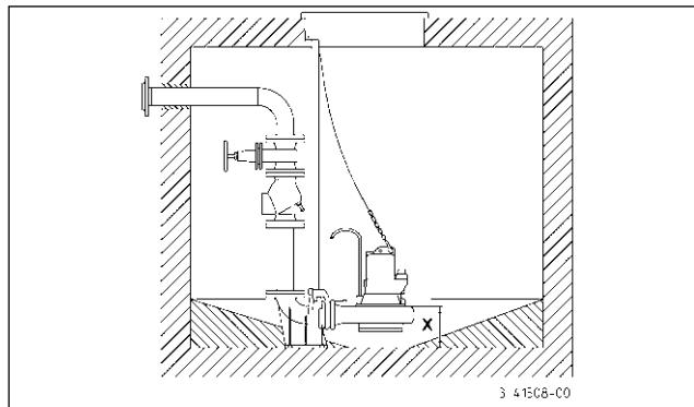
**Montáž:** Patku spojky připevnit hmoždinkami na dnu sběrné šachty a potom namontovat posuvnou trubku. Potom zmontovat tlakové potrubí včetně potřebných armatur, jako je zpětná klapka a uzavírací šoupátko.
