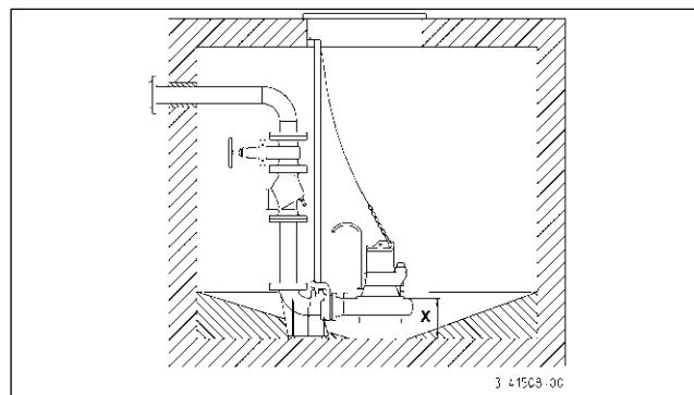
**Montagem:** Fixe firmemente a base do acoplamento no chão da câmara de coleta e, em seguida, Monte os trilhos de guia. Em seguida, instale o tubo de pressão, incluindo os acessórios necessários, como a válvula de retenção e as válvulas de corte. Por fim, instale a bomba com a trava de acoplamento aparafusada nos trilhos de guia e bixe-a para o lugar usando uma corrente presa à pega.
