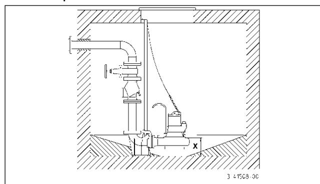
**Montage:** Den Kupplungsfuß fest auf dem Boden des Sammelschaches verdübeln und dann die Gleitrohre montieren. Danach die Druckleitung einschließlich der erforderlichen Armaturen wie Rückschlagklappe und Absperrschieber einbauen.
