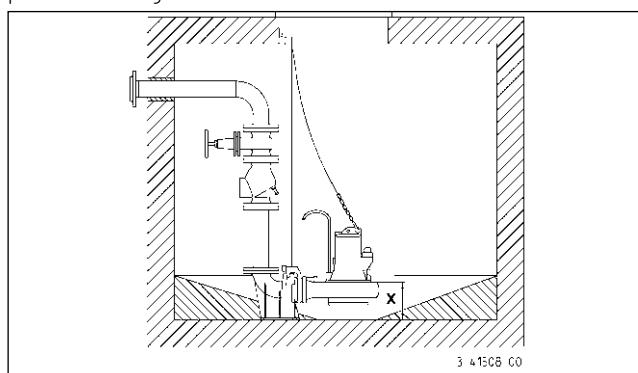
**Montaggio:** Ancorare il piede di accoppiamento saldamente al suolo del pozzo di raccolta e quindi montare le guide. Collegare il tubo di mandata con le dotazioni necessarie, valvole di ritorno e valvola a saracinesca.
