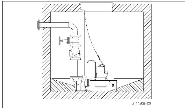
**Montaż:** Przymocować kotwami stopę łączącą na posadzce studni kolektorowej i następnie założyć rurę styczną. Następnie dokonać montażu rurociągu ciśnieniowego, włącznie z niezbędną armaturą jak klapy zwrotnie i zasuwły odcinające.
