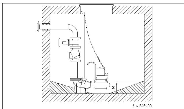
**Montáž:** Nohu spojky pomocou hmoždiniek upevnite na dne zbernej šachty a potom namontujte klzné rúrky. Potom zabudujte výtláčné potrubie vrátane potrebných armatúr ako je spätná klapka a posúvač.
