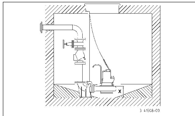
**Montage:** De koppelingsvoet stevig met pluggen op de bodem van de verzamelput vastzetten en vervolgens de schuivende buizen monteren. Vervolgens de drukleiding met de nodige hulpstukken zoals terugslagklep en afsluiter monteren.
