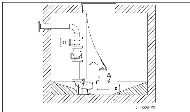
**Montage:** Cheviller fermement le pied d'assise au fond de la chambre collectrice, puis monter les tubes de glissement. Ensuite, installer la conduite de refoulement y compris les accessoires de tuyauterie tels que le clapet anti-retour et la vanne d'arrêt.
