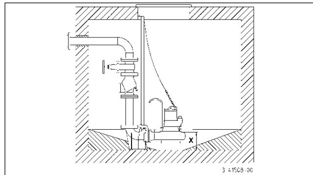
**Montering:** Dybla fast kopplingsfoten så att den sitter fast ordentligt i samlingschaktets botten och montera sedan glidrören. Montera sedan tryckledningen inklusive de nödvändiga armaturerna som backventilen och spärrventilen.
