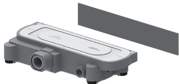
Bei freistehender Montage beiliegende Dämmplatte auf die Rückwand kleben. Die vier Füße unten in den Behälter montieren und das Gerät in der Höhe sowie waagrecht ausrichten.
