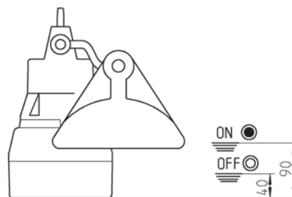
Основные размеры и уровни вкл. со спец. поплавком (мм)
