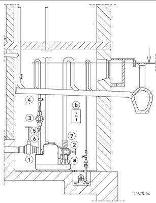
Gli impianti sono dotati di flangia di collegamento DN 80/PN 10, ma con bocchettoni di tubi DN 100. In caso di installazione diretta scegliere solo valvole di non ritorno e saracinesche di blocco in DN 80. La tubazione di mandata viene collegata con DN 100 mediante collegamento elastico.
