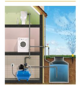
Serbatoio 50L per lo stoccaggio di una maggiore quantità di acqua e la riduzione delle operazioni di ripartenza della pompa.
